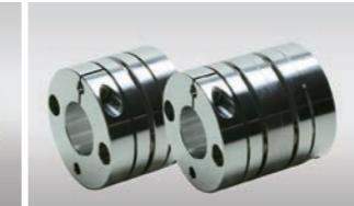
SFCモデルはバッテリー製造（二次電池）の現場で使用に懸念がある、銅・亜鉛・ニッケルが主成分ではないので、低露点環境（ドライルーム）での使用が可能です。標準品本体にアルマイト処理、ボルトには簡易防錆処理、固体潤滑皮膜処理を施しています。SFCの簡易クリーン仕様では表面処理は行わずにボルトをステンレス化しています。また、軸力確保のためのクランプボルト用グリスに、低発塵グリスとフッ素グリスの2種類から選択可能です。
