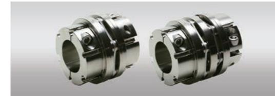
SFFモデルの簡易クリーン仕様は、本体とボルトの表面処理に無電解ニッケルめっき処理が施されています。また、クランプボルト用のグリスは、低発塵グリスとフッ素グリスの2種類から選択いただけます。バッテリー製造（二次電池）の現場で使用に懸念がある、銅・亜鉛・ニッケルが主成分ではないので、低露点環境（ドライルーム）での使用が可能です。
