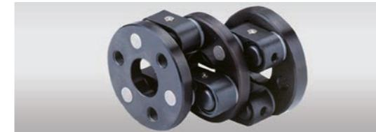
動力伝達にリンクのクランクモーションを利用しているため回転停止時、負荷運転中でも駆動、従動軸が変位範囲内で自由に平行移動できます。
