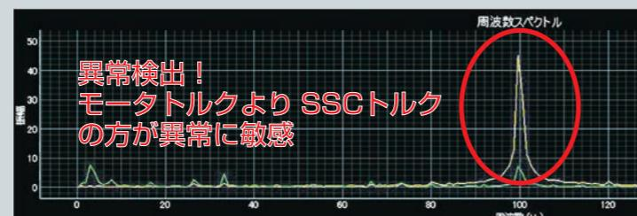
一般的にはモータ電流からトルクを算出できるため、センサ追加なしでライン全体の挙動を監視可能。
