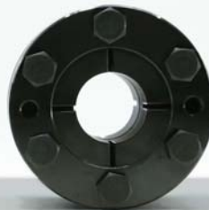
SRG-070DS 許容トルク 150 ~ 460N・m 適応軸径 \Phi 22 ~ 35mm
